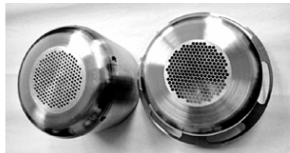
Рис.2. Общий вид эмиссионного (слева) и экстрагирующего (справа) электродов мультиапертурного диода
