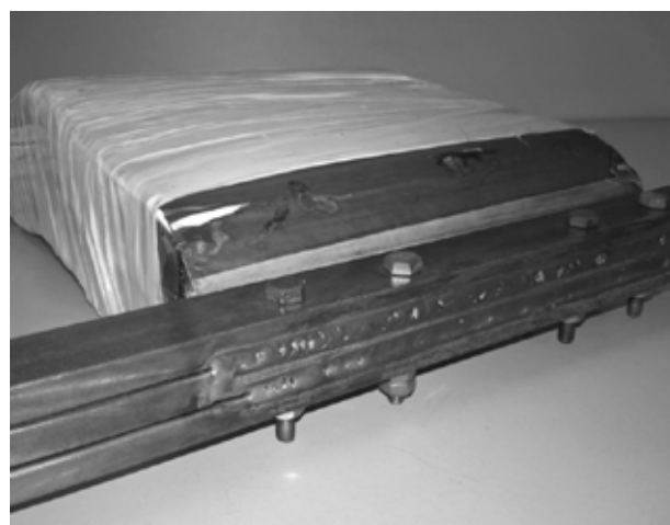
Рис.12. Фотографии алюминиевого ( a ) и медного ( б ) шинных выводов аккумуляторных батарей с пакетным набором электродов, сваренных электронным пучком в атмосфере
