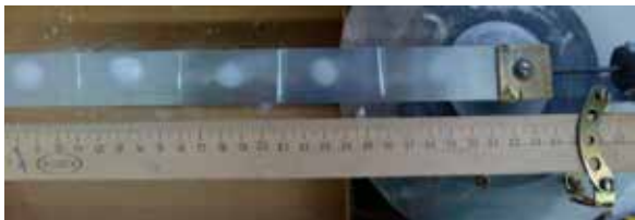
Рис. 1. Колеблющийся кантилевер с нанопорошком диоксида кремния на своей поверхности
